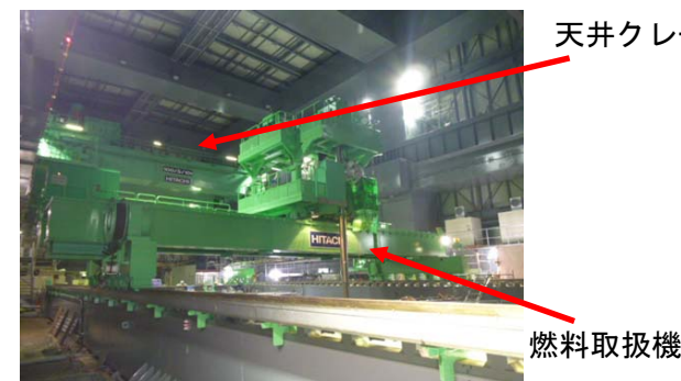
図5：4号機 天井クレーン、燃料取扱機の設置
