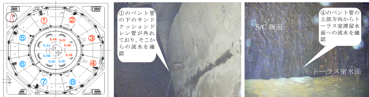
図8：1号機 サンドクッションドレン管及びベント管上部からの漏水状況
