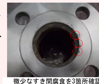
微小なすき間腐食を3箇所確認 供給ポンプ1出口配管フランジ C系統腐食対策有効性確認状況
