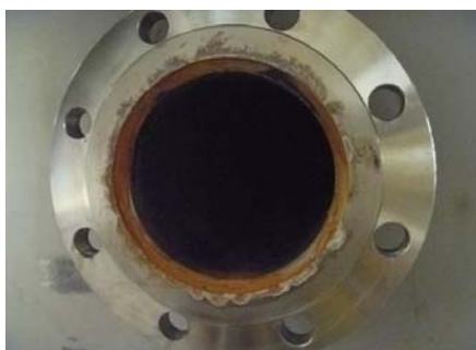
バッチ処理タンク2Aデカントノズル フランジシール面に すき間腐食有り
