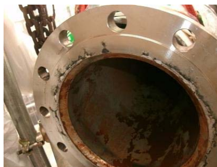
循環タンク戻り配管ノズル フランジシール面に すき間腐食有り
