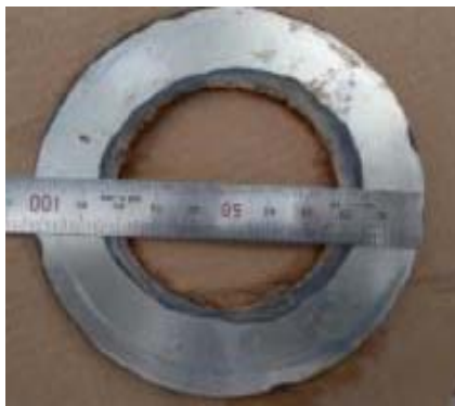
⑦供給ポンプ1出口配管 バスケット型犠牲陽極
