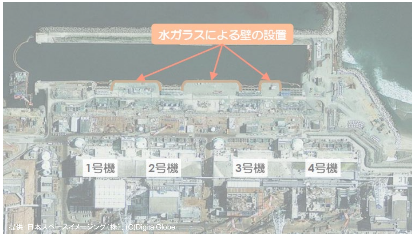
【水ガラスによる壁設置の対策箇所】
