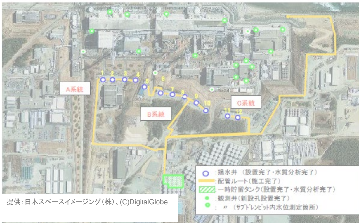
【地下水バイパス揚水井設置箇所】
