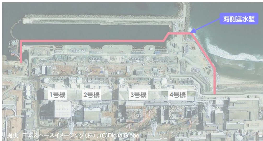
【海側遮水壁設置概略図】
