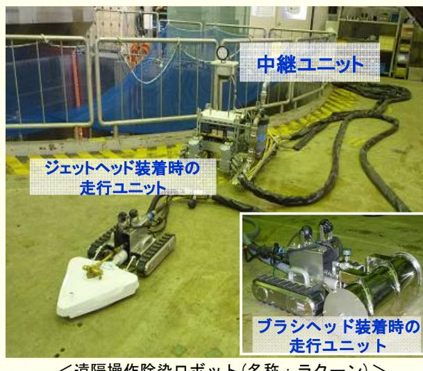
＜遠隔操作除染ロボット（名称：ラクーン）＞
