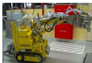
高圧水除染装置
