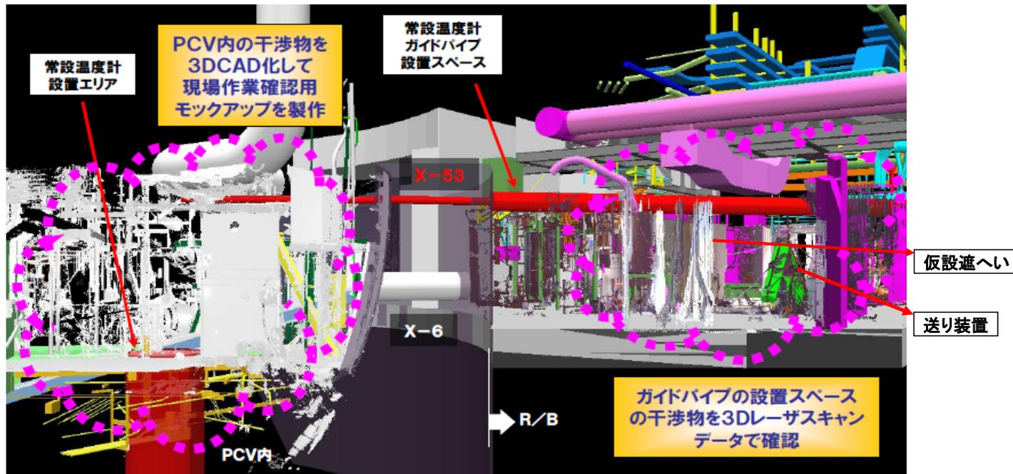
凡例 ■ 配管・ダクト ■ ケーブルトレイ ■ 躯体(床・壁・生体しゃへい) □(白):レーザスキャンデータ
