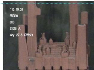
共用プール保管燃料調査状況 (8×8燃料の燃料集合体ロックナット部の外観)
