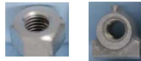
浸漬後(B型上部ロックナット、①条件) 浸漬後(B型下部タイププレート、①条件)
