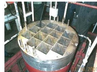
図1 東海再処理施設においてピンホール燃料等に使用する容器(燃料取り出し後)
