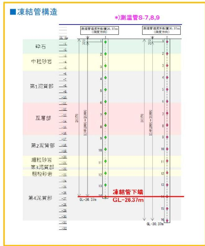
■測定データ【南北凍土壁面 中心測線】
