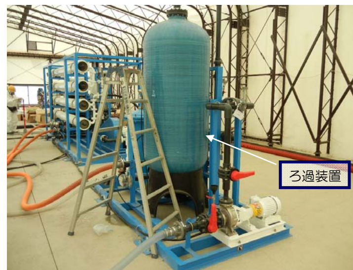
< 淡水化装置（ろ過装置） >
