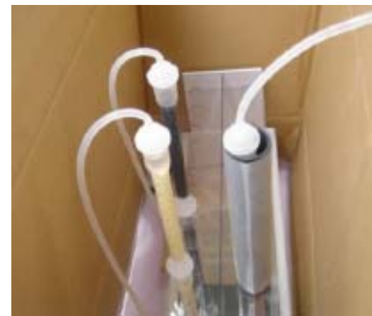
吸着除去性能確認試験装置
