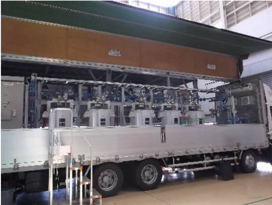
検証試験装置用吸着塔ユニット
