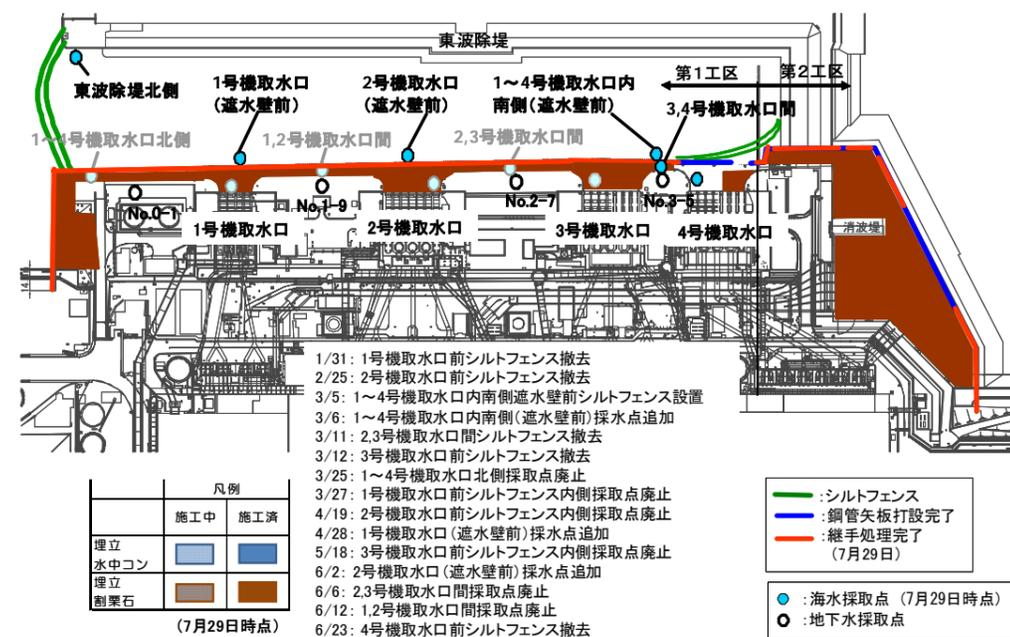
図8：海側遮水壁工事の進捗状況
