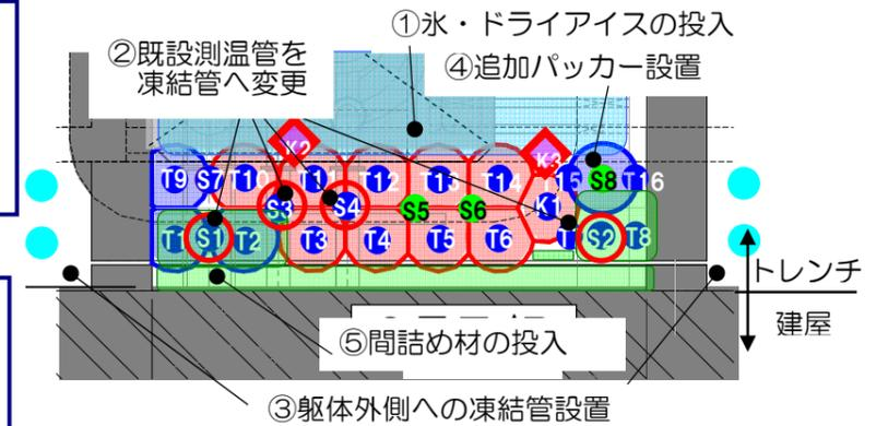
図5：2号機立坑A凍結止水対策
