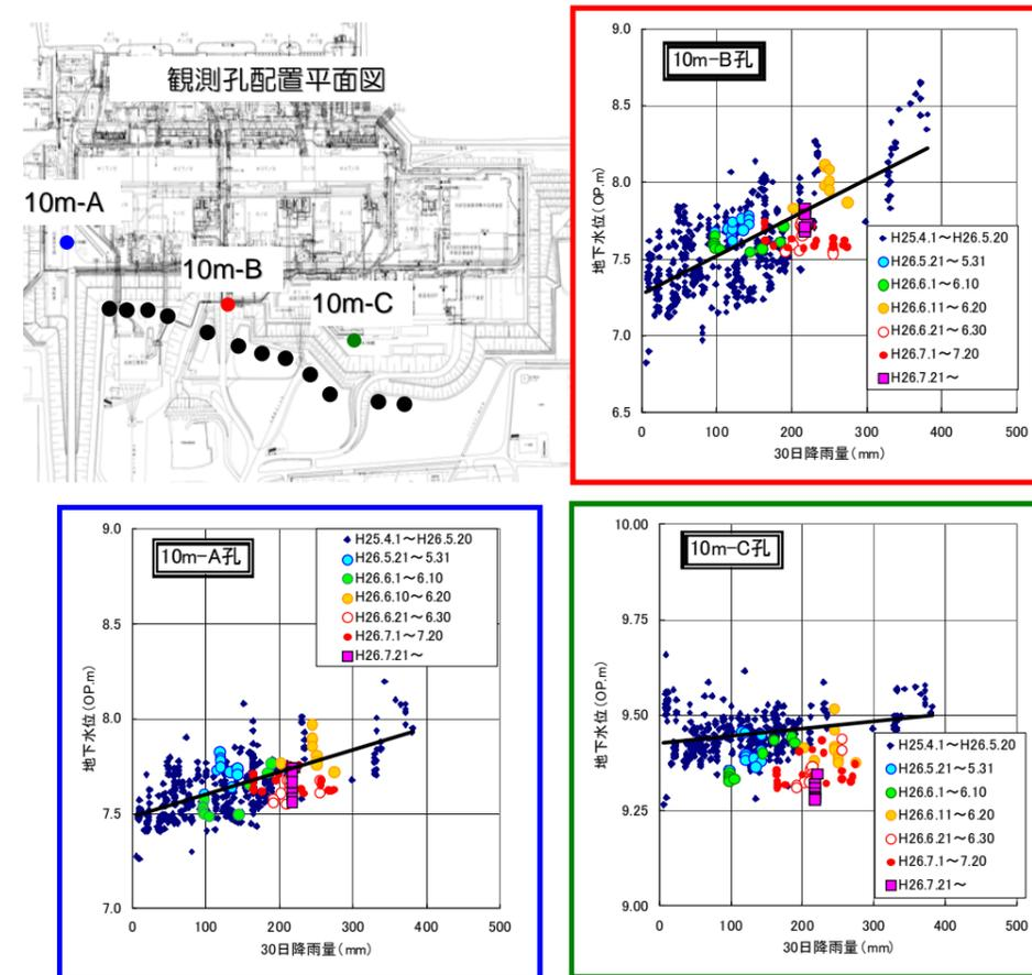
図1：地下水バイパス観測孔の水位
