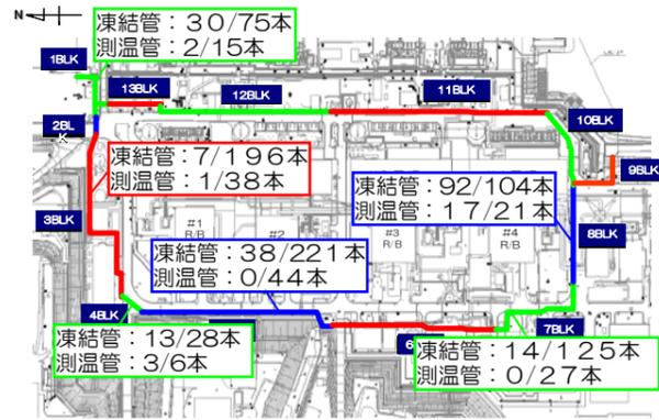
図2：凍結管設置のための削孔工事状況
