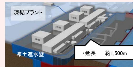
建屋への地下水流入を抑制するため、凍土壁で建屋を囲む陸側遮水壁の設置を計画。今年度末の凍結開始を目指し、6/2から凍結管の設置工事中。
