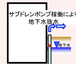
サブドレン水汲み上げによる地下水位低下に向け、1～4号機の一部のサブドレンピットについて浄化試験を実施。今後、サブドレン復旧方法を検討。
