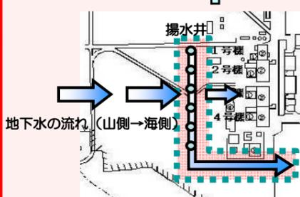
山側から流れてきた地下水を建屋の上流で揚水し、建屋内への地下水流入量を抑制する取組(地下水バイパス)を実施。くみ上げた地下水は一時的にタンクに貯留し、東京電力及び第三者機関により、運用目標未達であることを都度確認し、排水。揚水井、タンクの水質について、定期的にモニタリングを行い、適切に運用。建屋と同じ高さで設置した観測孔において地下水位の低下傾向を確認。
