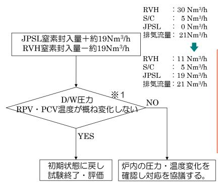
※1:試験中に判断基準を満たさない場合には、ガスバランスを元の状態に戻す。本試験により、RPVへの封入が期待できるラインを少なくとも1ラインは確保したいため、D/W圧力低下またはHVH温度上昇が確認された場合には、RPVに封入できていない可能性があるため、試験を一時中断し、別のラインを用いた試験工程を調整し試験を継続する。
