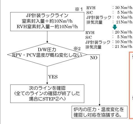
※1: JP計装ラックラインからの窒素封入量が10Nm³/h確保できない場合は、最大窒素封入量で試験を継続する。他のラインに比べて最大窒素封入量が数Nm³/h大きい場合には、想定通り封入できていない可能性があり注意して試験を継続する。
