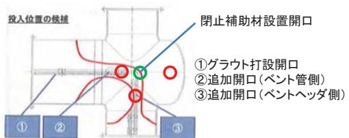
1. 干渉物の撤去: 補修装置(マニピュレータ)により干渉物を撤去し、閉止補助材が良好に展開できるようにする。
