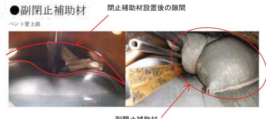
※試験では土嚢袋を使用して、グラウト充填し、隙間部に設置した。
