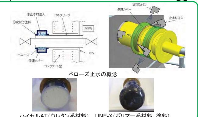
ハイセルAT(ウレタン系材料) LINE-X(ポリマー系材料、塗料)
