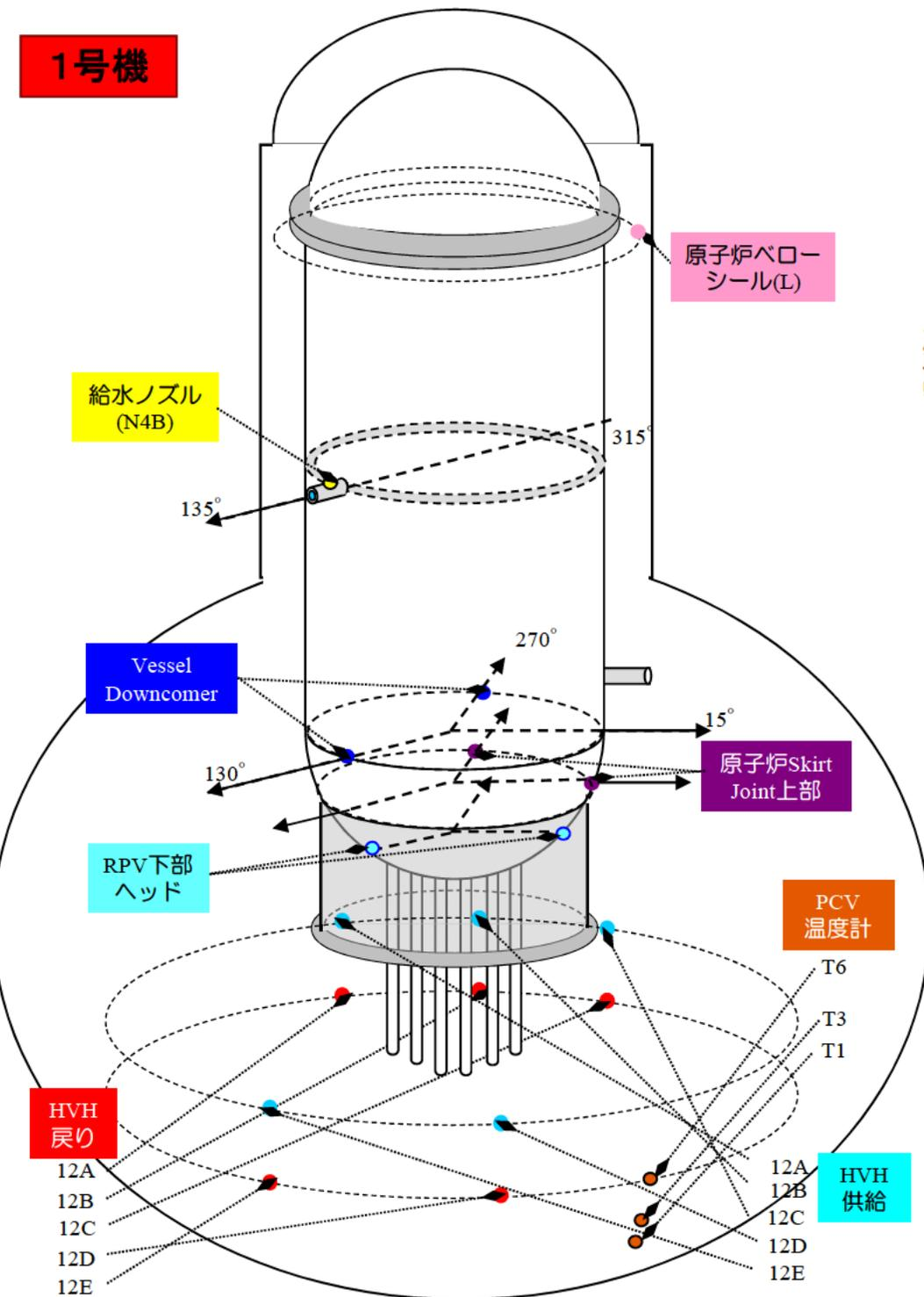
1号機 原子炉圧力容器まわり温度(4/26~7/30)
