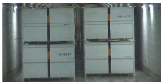
角型容器 (高線量瓦礫類)
