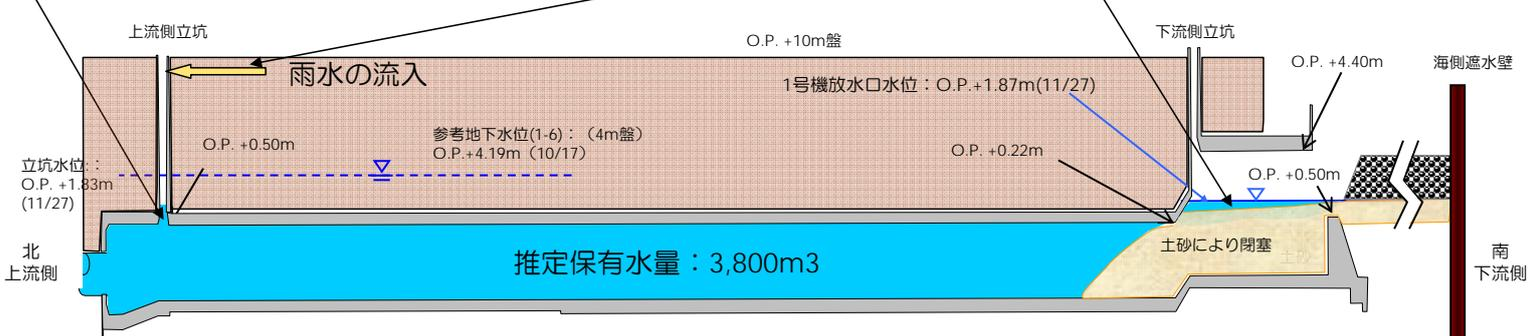
1号機放水路縦断面図+水位+土砂堆積状況(縦横比1:5)
