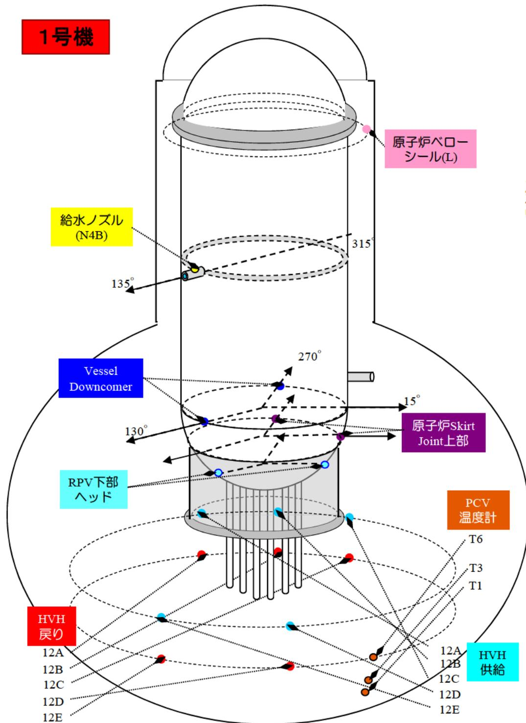
1号機 原子炉压力容器まわり温度(10/26~1/28)
