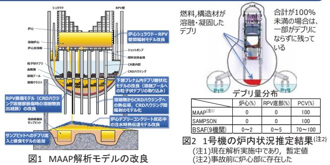
図1 MAAP解析モデルの改良
