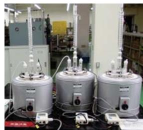
図2 長時間腐食試験の状況
