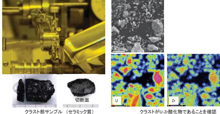
図 TMI-2デブリの切削作業と切断粉のSEM/EPMA観察結果
