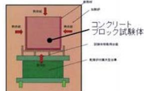
図3 コンクリート加熱試験のイメージ
