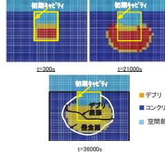
図2 1号機の炉内状況推定結果<sup>(注2)</sup>
