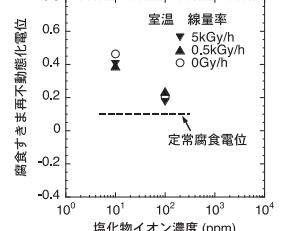
図4 希釈人工海水中での腐食すきま再不動化電位と塩化物イオン濃度の関係
