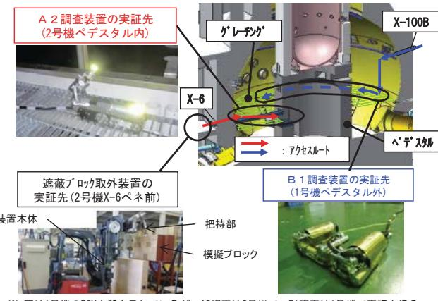
※ 図は1号機のPCV内部を示しているが、A2調査は2号機で、B1調査は1号機で実証を行う
