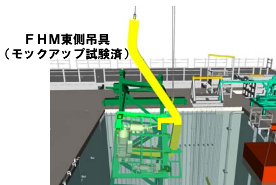
FHM東側をFHM東側吊具を挿入し、吊上げ、撤去
