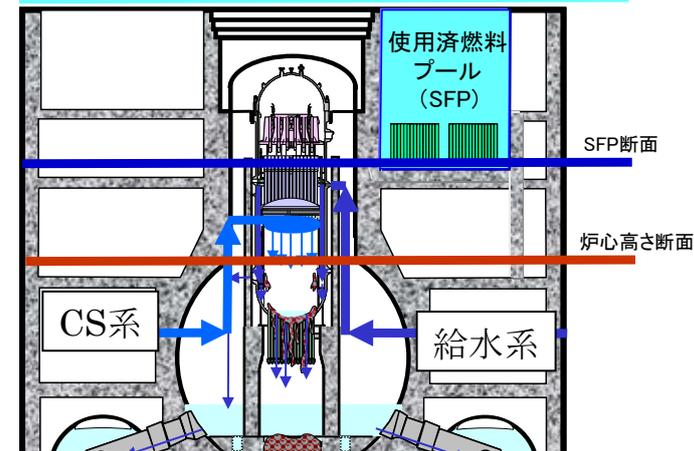
図1 原子炉建屋の配置図(上:5階オペフロ、下:断面図)
