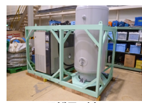
エアドライヤー・ レシーバタンク
