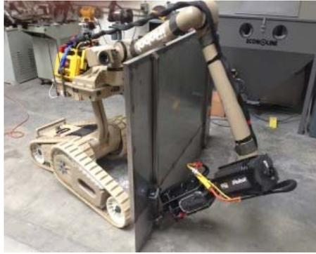
1枚のフェンスにつき2箇所が地面に固定されており、最初に脚部を切断する。
