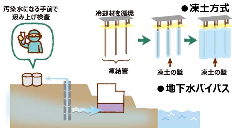
※凍土方式 = 土を凍らせる方法
