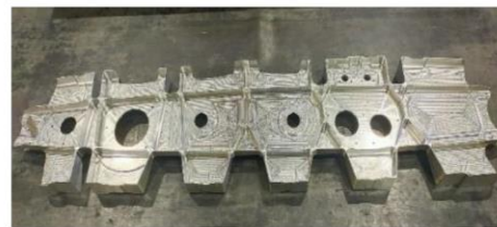
（航空機主翼 RIB アルミ部品事例 全長～3 m）
