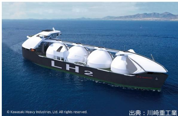
液化水素運搬船：160,000m<sup>3</sup>（4タンク分）
