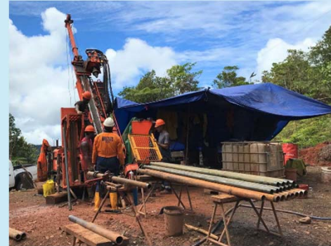
海外における地質構造の把握のためのボーリング調査
