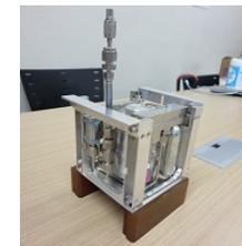
推進剤を従来の人体に有毒なガスではなく、液化ガスにし、ガス化して推力を得る小型衛星用推進系を開発。
