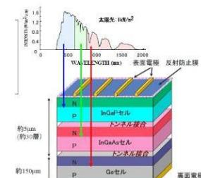
〈タンデム型太陽電池の断面図イメージ〉
