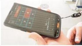
給油許可に用いるタブレット端末型装置
