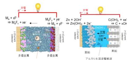
ハロゲン化物電池 亜鉛負極電池
