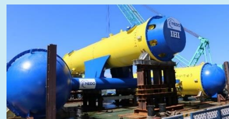
平成30年度採択 「水中浮遊式海流発電（株式会社IHI）」 実証機仕様 定格100kW（50kW×2機、流速1.5m/sec）
