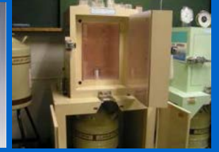
ゲルマニウム半導体検出機 製品中の放射能測定、放射性物質の種類特定。
