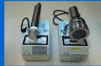
GMサーベイメーター 製品表面の残留放射線量を測定
