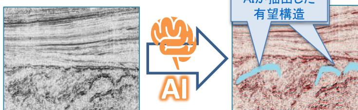
＜AIによる地震探査データからの有望構造抽出のイメージ＞
