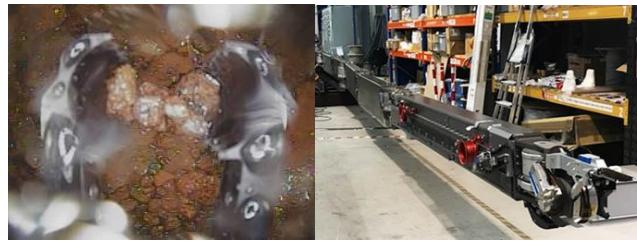
2号機格納容器の内部調査 燃料取り出しの為のロボットアーム
