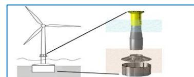
＜基礎構造・施工技術のコスト低減に向けた技術開発・実証の例（サクションパケット基礎）＞
