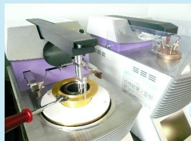
潤滑油試験精度の確認・確保 ※品質試験装置(引火点)
