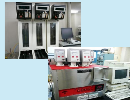
潤滑油試験精度の確認・確保 ※品質試験装置(粘度)
