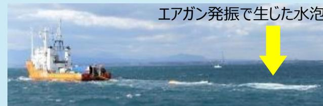
海底下地層の弾性波探査
