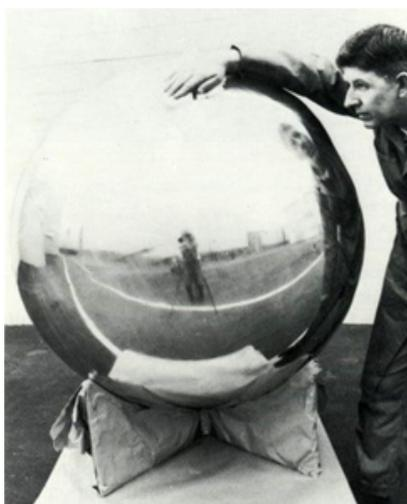
図表 1-24 : Lincoln Calibration Sphere は、今日でもレーダーセンサーのキャリブレーションに使用されている。直径 1.12m で、1965 年に打上げられた (Gunter の宇宙ページ : [https://space.skyrocket.de/doc\\_sdat/lcs-1.htm](https://space.skyrocket.de/doc_sdat/lcs-1.htm))
