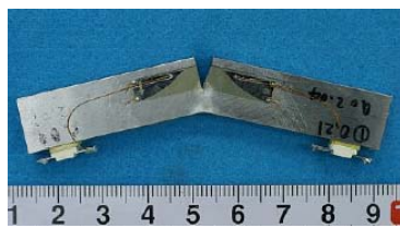
＜疲労き裂進展試験後の試験片外観＞
