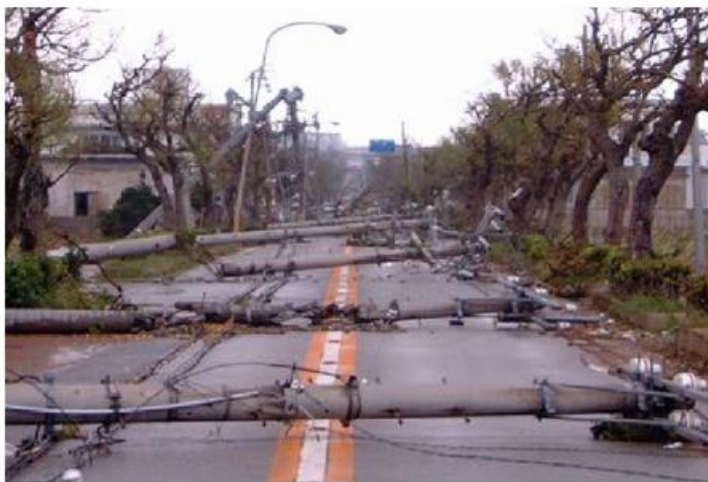
図 5-1 電柱の連鎖倒壊と支線の事例 16
