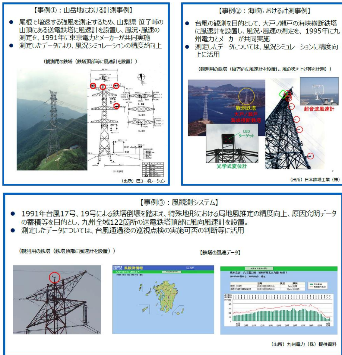
図 4-6 風況・風向の測定の事例 16
