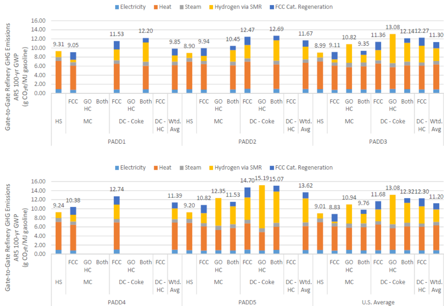
図 4-5 ガソリン精製時 GHG 排出量の算定結果
