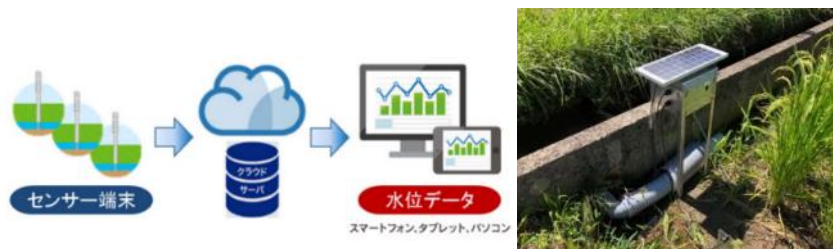
図表 16 水田センサーの仕組み（左図）と自動水門装置（右図）
