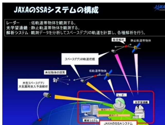
図 2-2 JAXA の SSA システムの構成
