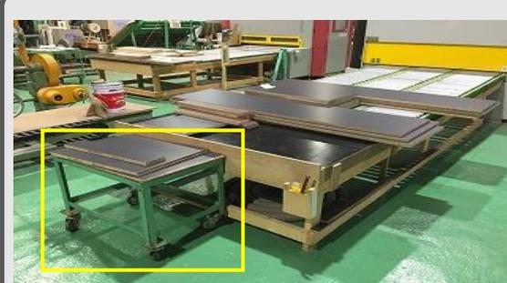
○コロコン台が投入口から遠いため、台車への材料積み替え作業が発生している。
