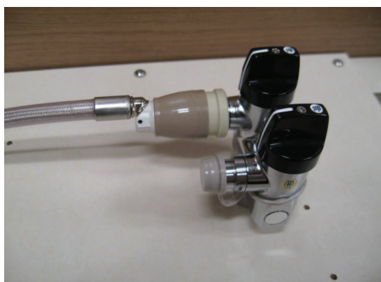
コンセント口に装着したガス栓キャップ
