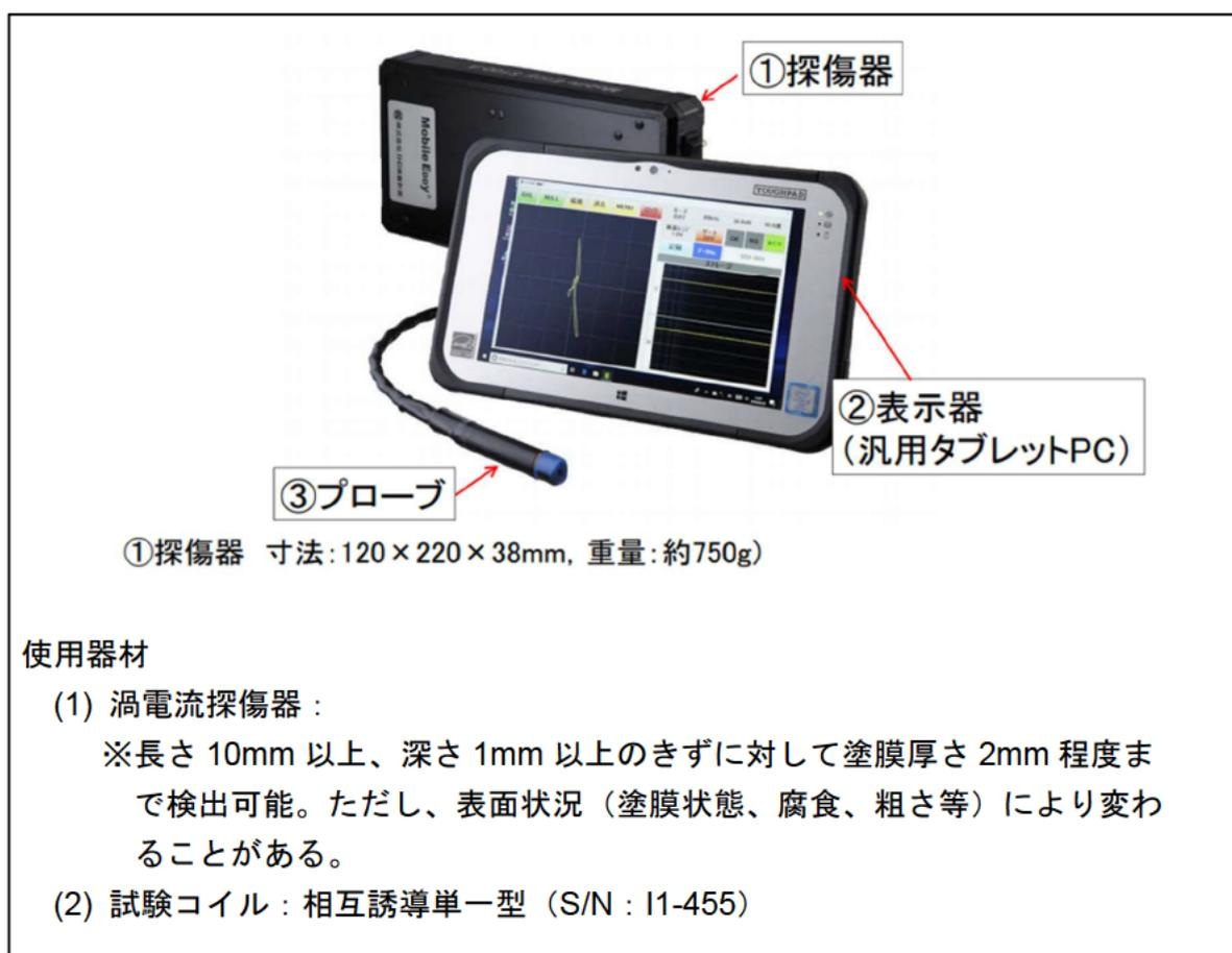
表 6.4.3-2 渦電流試験 作業例
