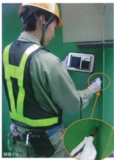
表 6.4.3-1 渦電流探傷試験装置 器材
