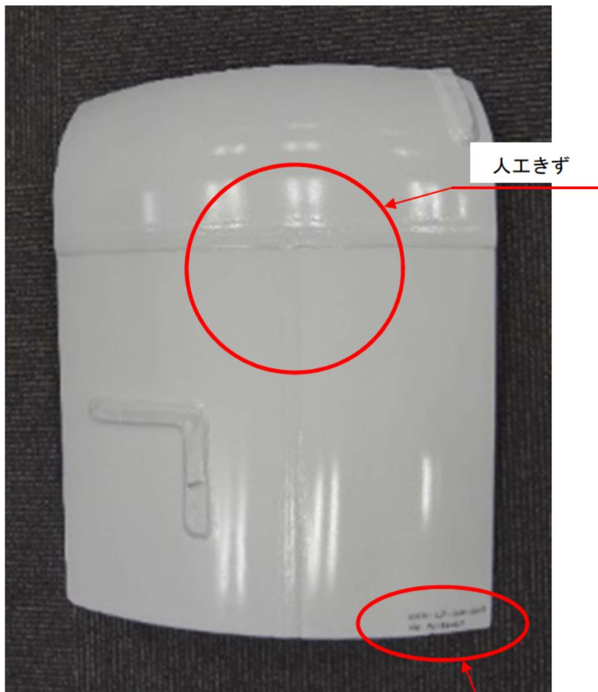
図 6.3-1 人工きず用標準試験片
