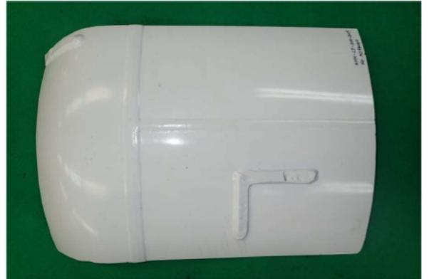
人工きず試験体写真
