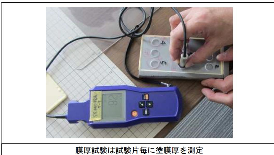
図 5.4.1-1 塗料塗布試験片塗膜厚測定
