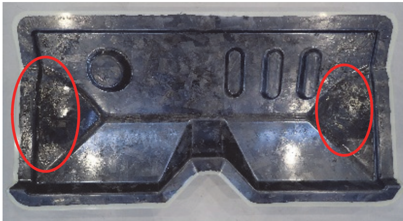
図 2-42. SGL 社製の rCF 製マット材による RTM 成形結果 (Vf25%の C-RTM 成形結果、赤丸部分がドライスポット)
