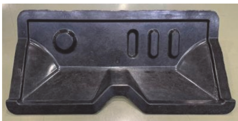
図 2-41. SGL 社製の rCF 製マット材による RTM 成形結果 (Vf12%の HP-RTM 成形結果)
