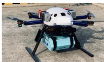
短距離(マルチコプタ) 航続距離: ~ 15km Payload: ~ 1.7kg
