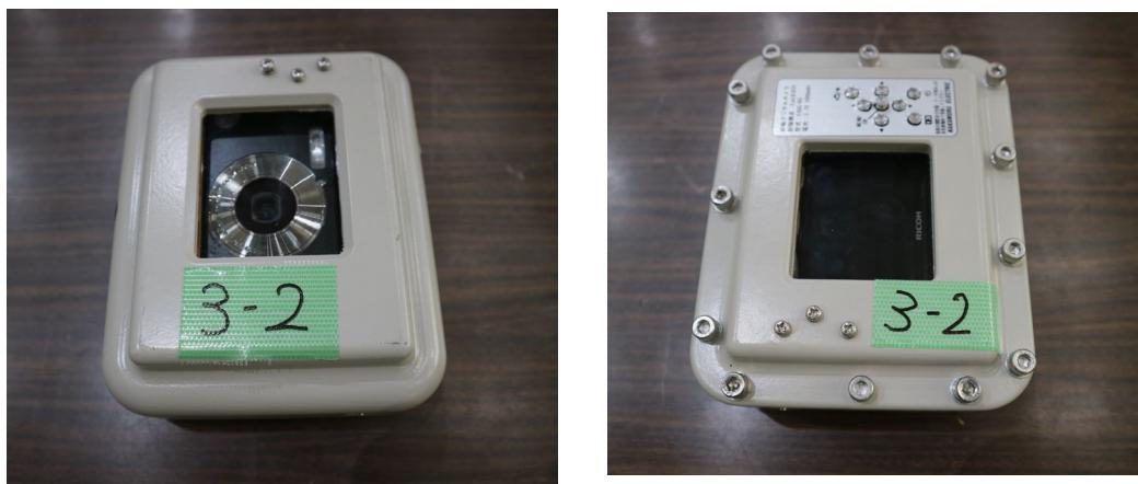
図 8-14 No.3-2 E 社製耐圧カメラケース(鉄製 + ガラス)
