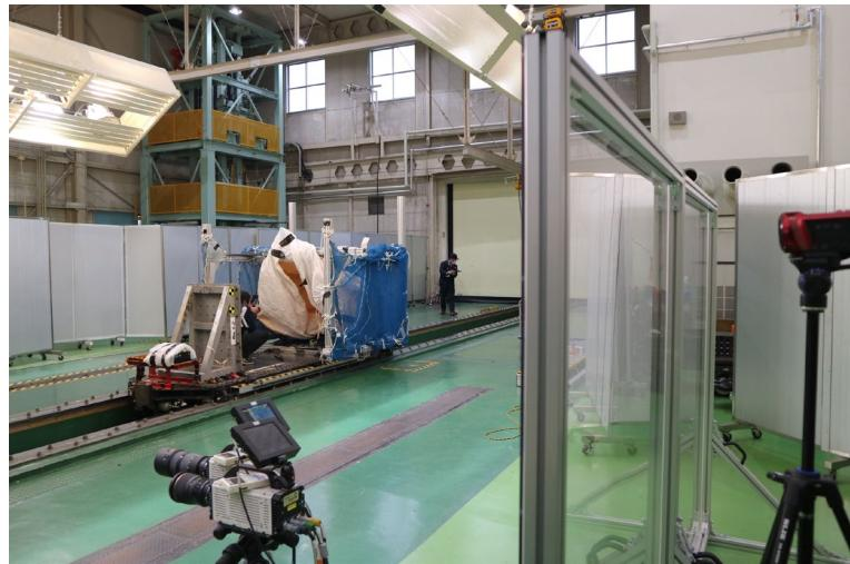
図 8-5 衝撃試験装置(HYGE)(ショット後の台)
