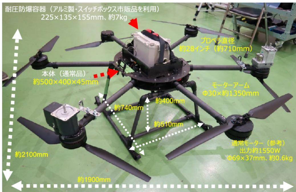
図 8-6 No.1-1 模擬防爆ドローン
