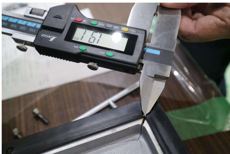
図 8-26 No.2-1 ショット後の防爆容器破損箇所、D 社製安全増防爆容器(アルミ鋳製)
