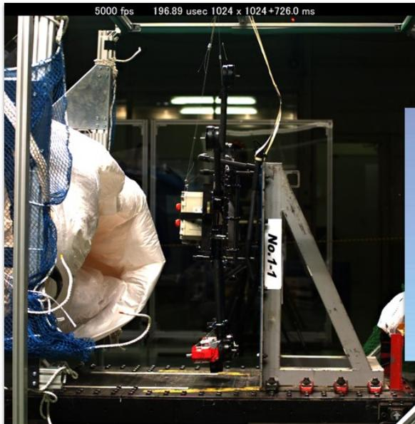
図4 防爆構造+ドローン 衝撃試験の様子
