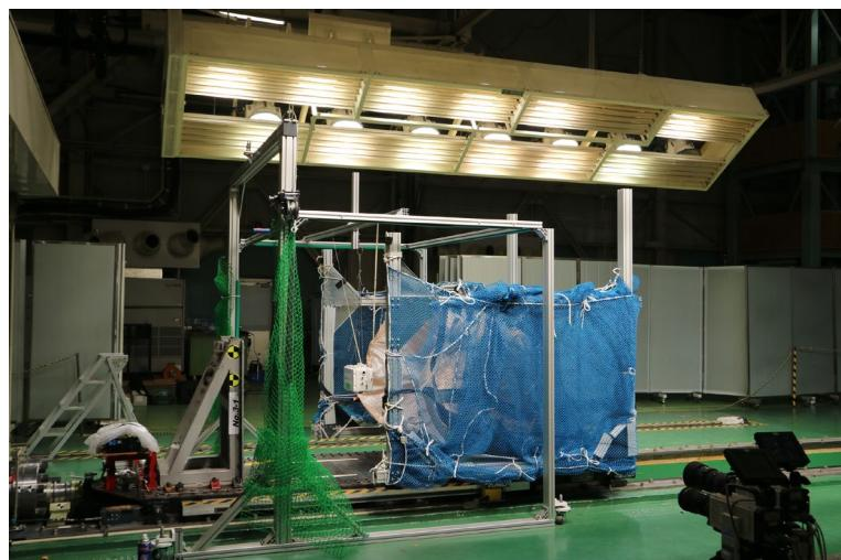
図 8-4 衝撃試験装置(HYGE)(カメラの設置状況)
