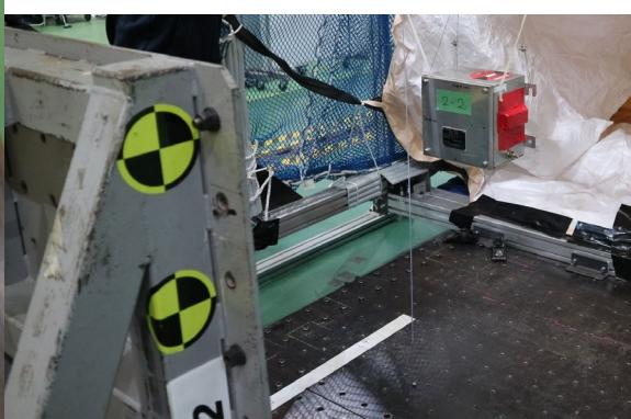
図 8-12 No.2-2 D 社製安全増防爆容器(ステンレス製)
