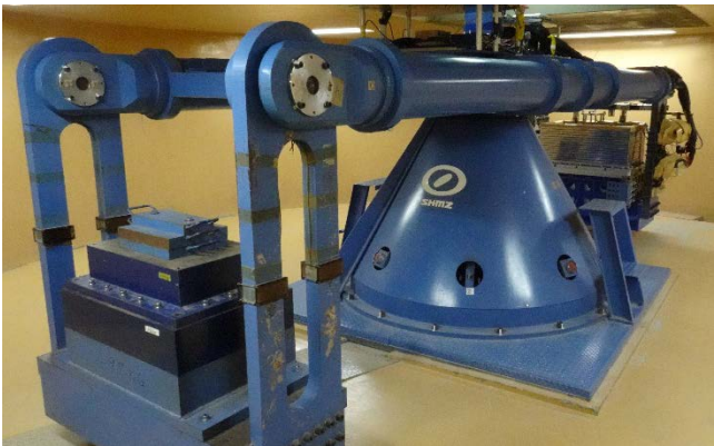
写真 2.1-1 遠心模型振動実験装置の外観
