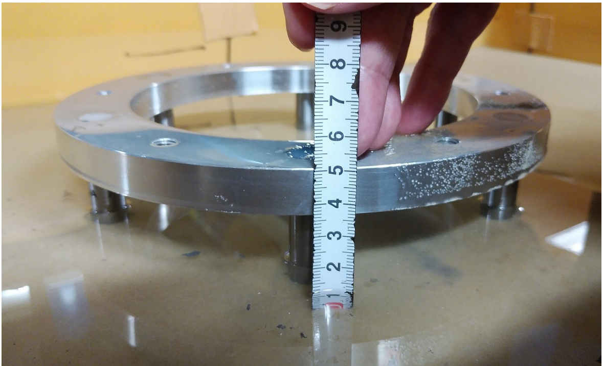
写真 2-10 正弦波加振後の地盤沈下の様子
