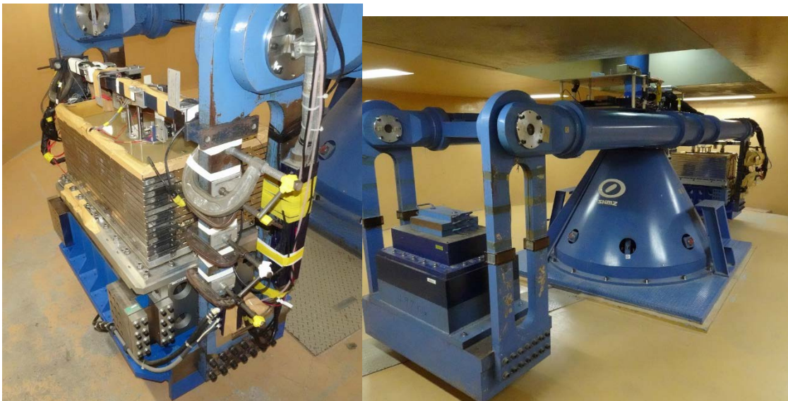
写真 2-6 試験体の遠心载荷装置への設置
