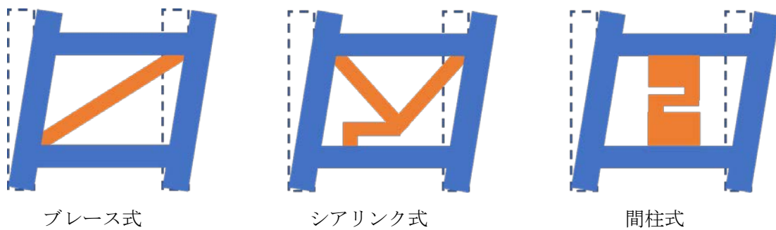
参考図 5. 制振ダンパの代表的な設置方法
