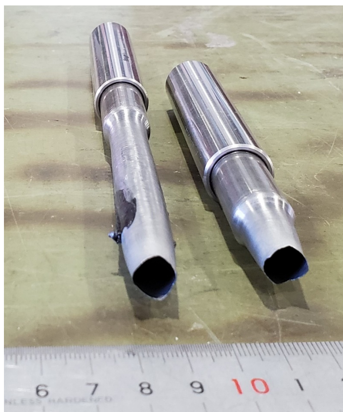
写真 3-1 模型杭の最終破断状況
