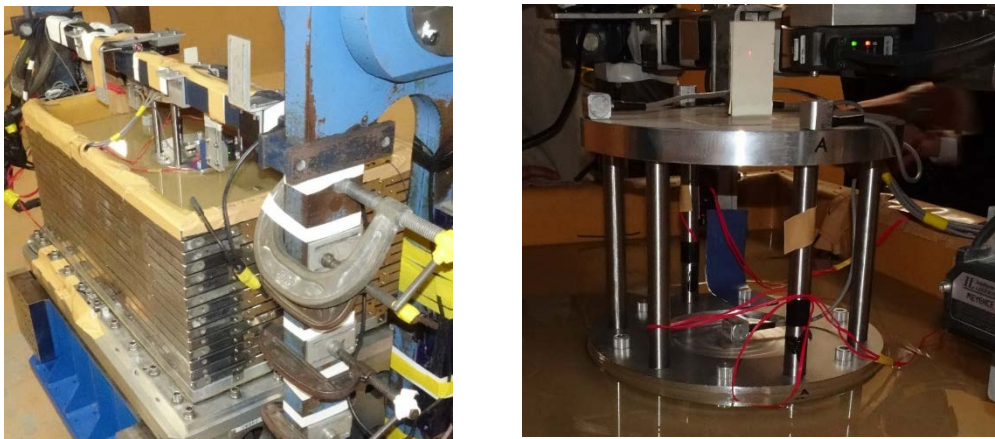
写真 2.2-1 遠心模型振動実験モデルの外観
