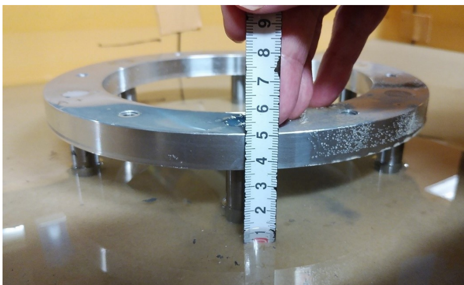
写真 3.3-1 加振終了後の地盤沈下の様子
