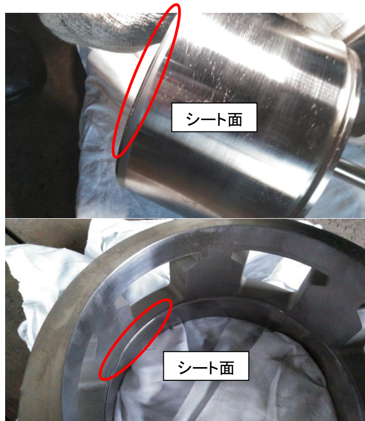
図 4 圧力制御自動弁のシート漏れの状況
