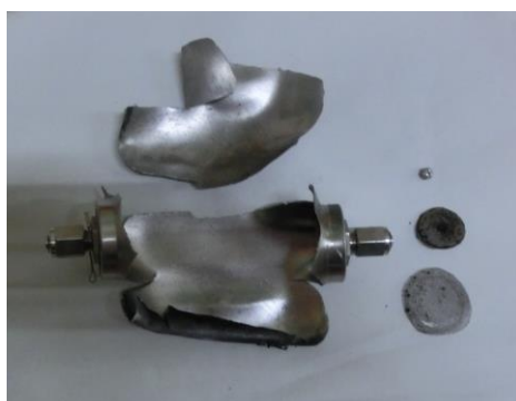
図3 爆発したガス精製器
