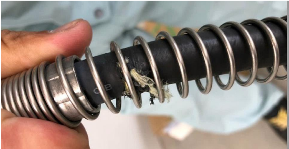
図 1 充填ホース破損の状況
