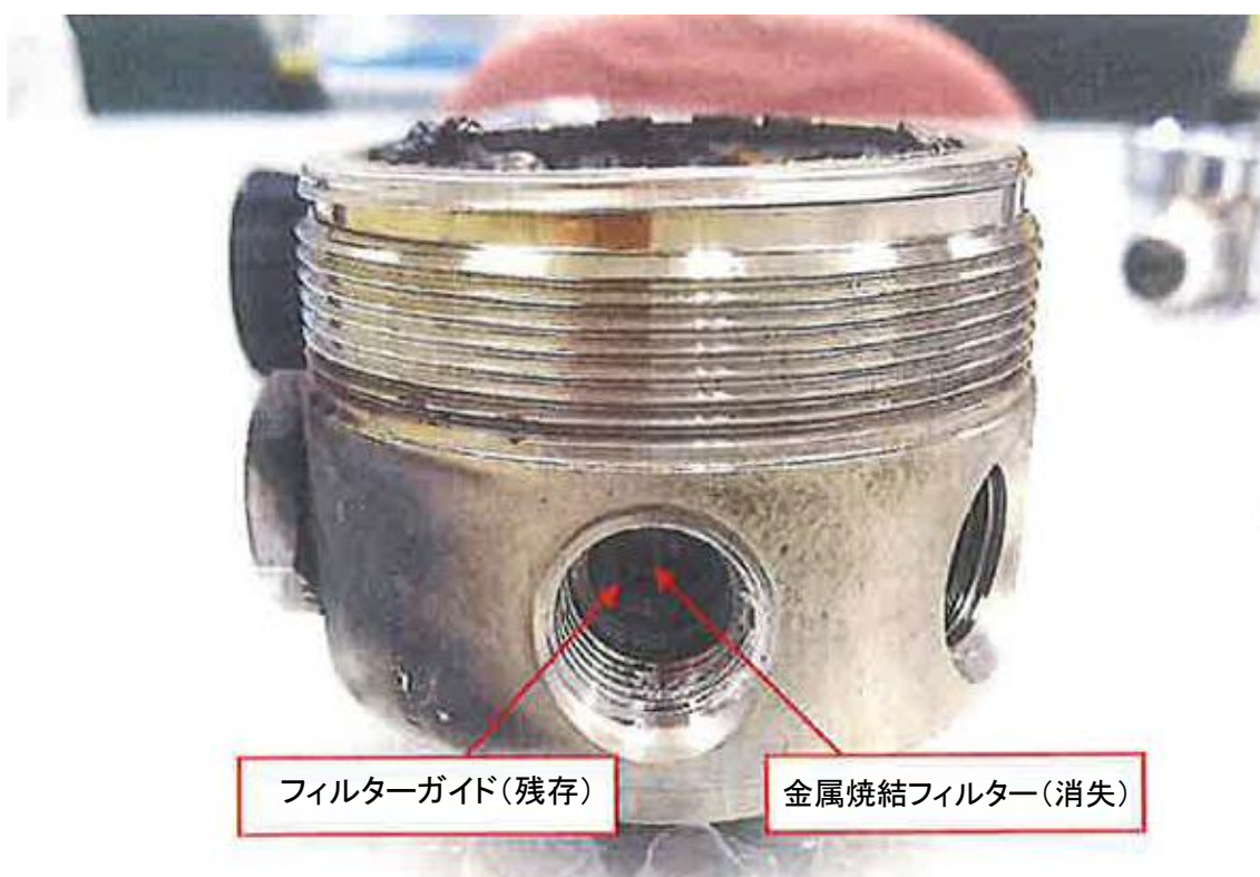
図 4 焼損した圧力調整器の入口ポート(容器バルブ側)
