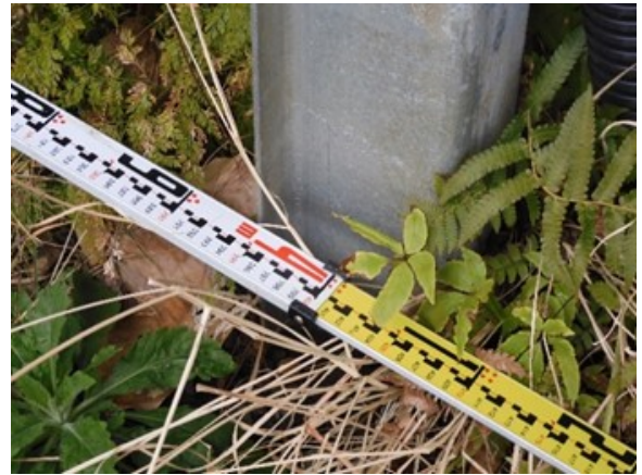
写真 11 杭長手方向の間隔（現地調査）
