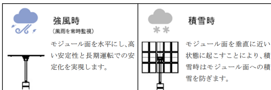
図 3-1 強風時及び積雪時のモジュール面
