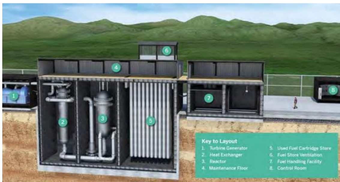
図 2.3.4-2 U-Battery プラントの配置[1]
